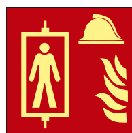
Ref. 17 Ascensor para los servicios de emergencia
